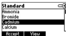
Seleccione el electrodo deseado con las teclas **FLECHA**.
